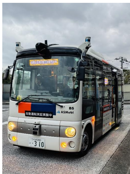
カメラやセンサーなどを多数装備した実証実験用の自動運転バス 出所：浜銀総研撮影
